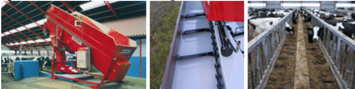
Figuur 2.2 Cormall voersysteem met vast voermengbak en meenemers
