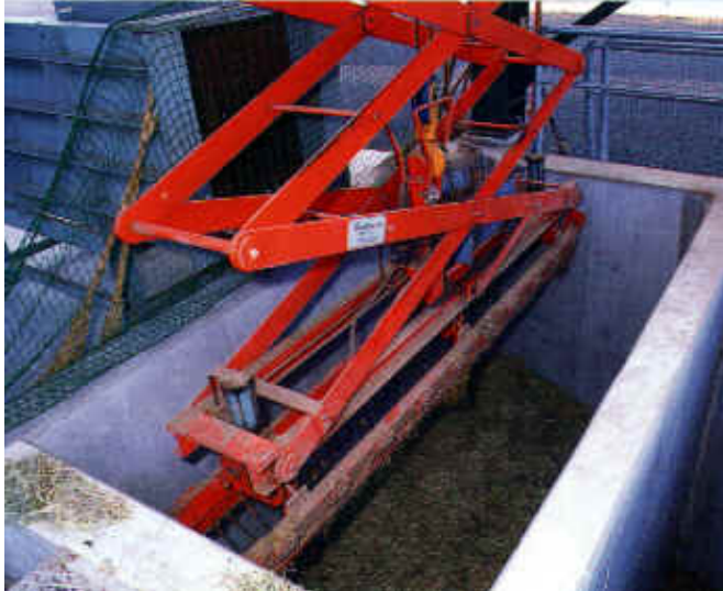
Figuur 2.5 Silokraan haalt voer uit vierkante voorraadbunkers
